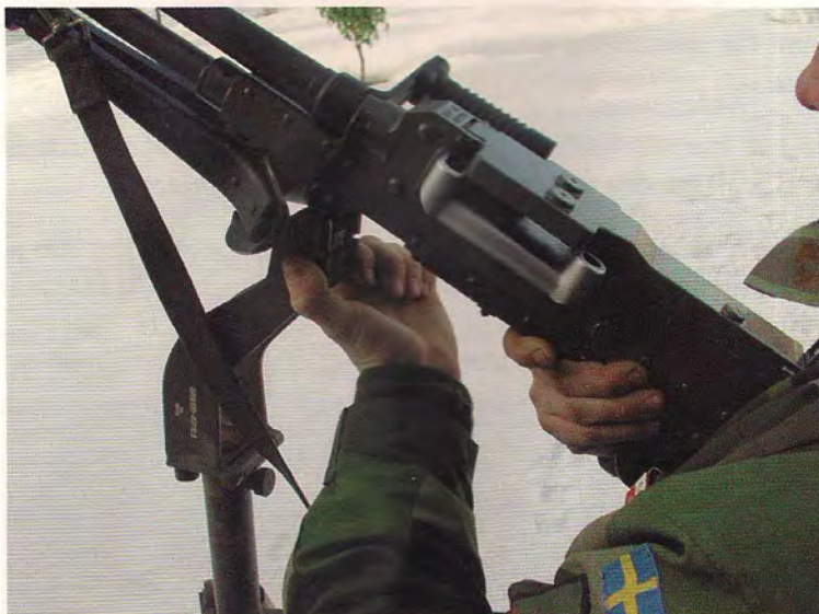
Fastsättning av ksp i stativ
