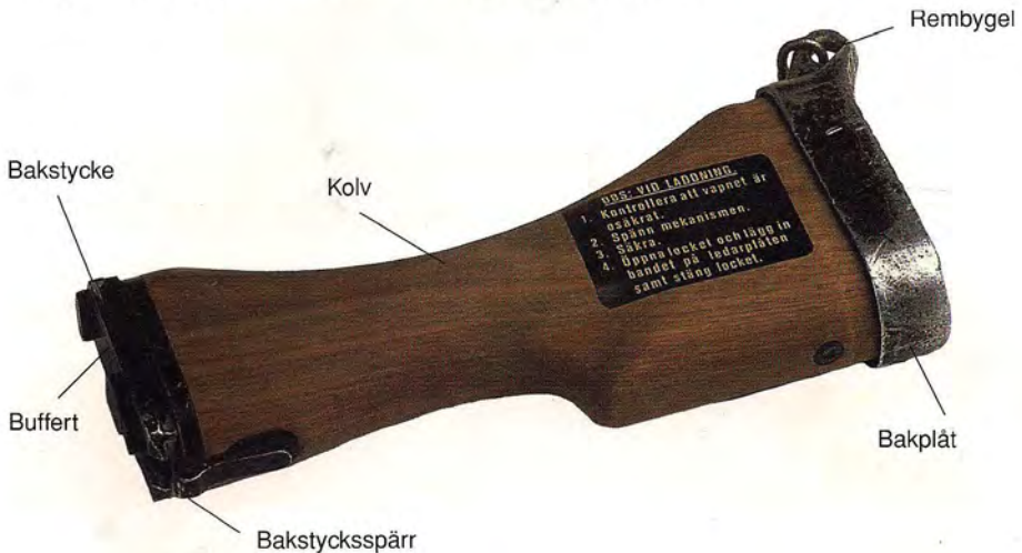
Kolv med bakstycke och buffertanordning.
